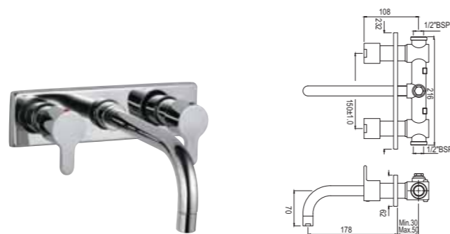
FUS-29433 Смеситель для раковины настенный встраиваемый, с вентилями для горячей и холодной воды Расход воды: 15.1 л/мин*
